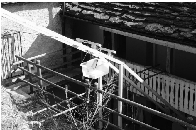
Bilder 27-29: die Kiste bleibt immer in waagrechter Position, egal welche Steigung sie durchläuft.
