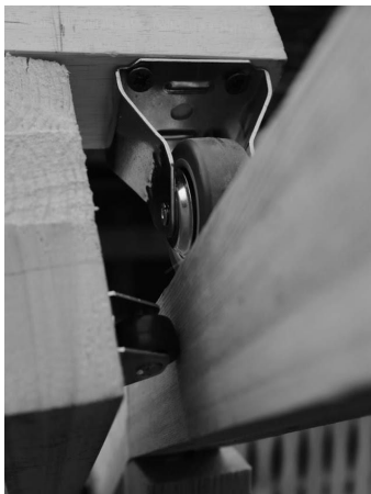
Bild 8: die grösseren Räder am Schlitten fahren auf den Schienen, die kleinen sorgen für eine genaue Führung
